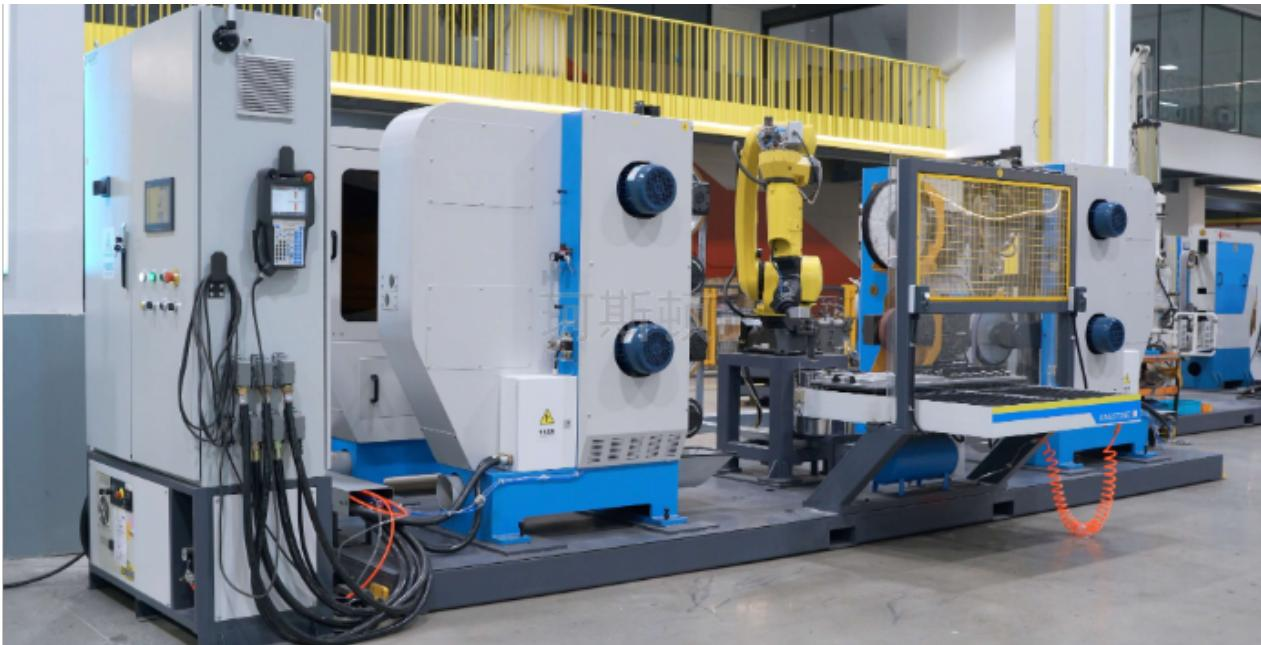
保温杯打磨生产线，包括依次设置并用于逐一输送保温杯的上料装置、若干个打磨装置与若干个抛光装置，还包括若干个用于将保温杯转移至打磨装置或抛光装置处进行打磨或抛光的工业机器人，若干个打磨装置与若干个抛光装置分别与若干个工业机器人一一对应设置，打磨装置包括砂带机机架，砂带机机架上设有砂带机构，砂带机构包括砂带主梁、驱动电机、主动轮、从动轮以及砂带，从动轮通过从动支架装设于砂带主梁，砂带主梁与砂带机机架之间设有浮动打磨组件，浮动打磨组件包括浮动臂，浮动臂两端均设有轴承柱，浮动臂通过轴承柱与砂带主梁和砂带机机架活动连接，并使砂带主梁通过浮动臂在砂带机机架内左右摆动。
