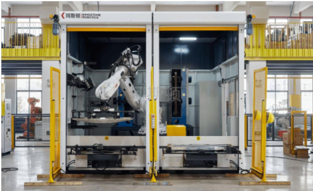
打磨机器人一般是由示教盒、控制柜、机器人本体、压力传感器、力控磨头组件等部分组成，可以在计算机的控制下实现连续轨迹控制和点位控制。抛光打磨，是机械制造业、加工业、模具业等众多行业中的重要工序之一。而机器人在这一制造工序中，有着极为广阔的应用，无论是打磨、抛光，还是去毛刺，现在都可以看到机器人繁忙的身影。伴随着国内汽车零部件和工业产品加工企业及五金等行业企业对抛光打磨机器人需求量的增长，近年来国内抛光打磨机器人安装量呈现快速增长态势。浙江珂斯顿机器人科技有限公司是一家专业提供机器人抛光的公司，有想法的不要错过哦！湖北非金属机器人抛光规格
